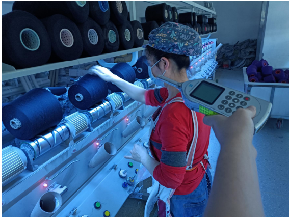
2F 车间络筒岗位
